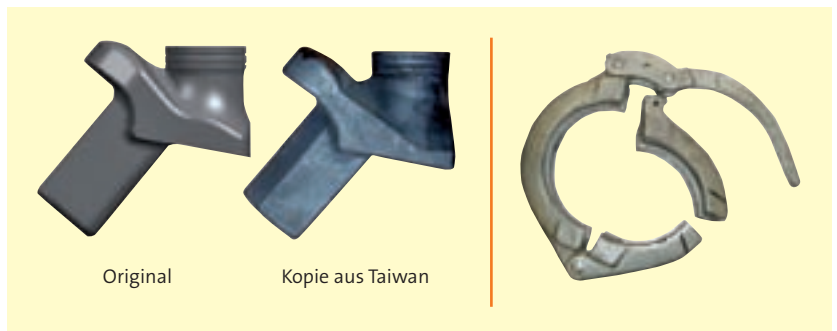
Original und Kopie sehen sich meist sehr ähnlich (Bild links). Im Bild rechts ist ein gefälschtes Produkt zu erkennen. Es war der Belastung durch den Betrieb nicht gewachsen, während das Originalteil der Beanspruchung standgehalten hätte. Fotos: Wirtgen/Putzmeister
